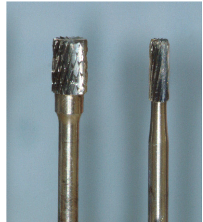
Abbildung 10 Ausgefräste Prothese zur Aufnahme der Housings (Fräsen H296 E 104 040, H260 104 023 der Firma Komet Dental, Lemgo, Deutschland).
