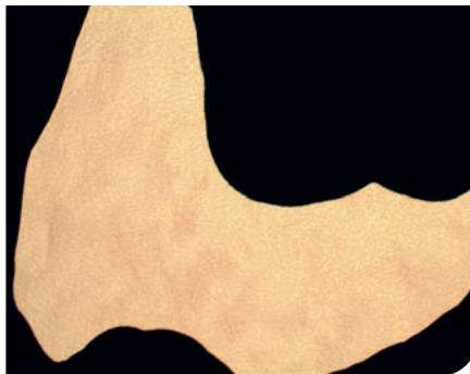
**Abb. 3** Homogenes, lunkerfreies und feinkörniges Gefüge einer Krone [C. Hafner Edelmetall, CAD/CAM-Blank aus einer Pd-Cu-freien Legierung].
