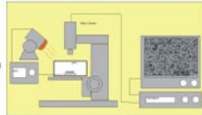
Abb. 1: Schematische Darstellung der zeitraffenden Videomikroskopanlage
