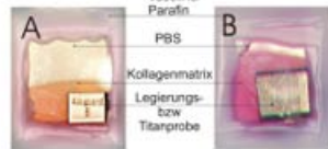
Abb. 2 A + B: In Kollagenmatrix eingebetteter Legierungs- (A) bzw. Titanprobekörper (B)
