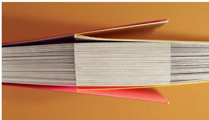
**Abb. 6** Zwei Bücher, mit den einzelnen Seiten ineinander verzahnt, können aufgrund der großen Kontaktfläche und Oberflächenrauigkeit des Papiers (Retentionen) nur mit hoher Kraft auseinandergezogen werden.
