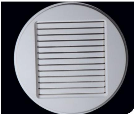
**Abb. 1** Frästechnische Prüfkörperherstellung für 3-Punkt- oder 4-Punkt-Biegeprüfung aus Zirkonoxid (ungesintert).
