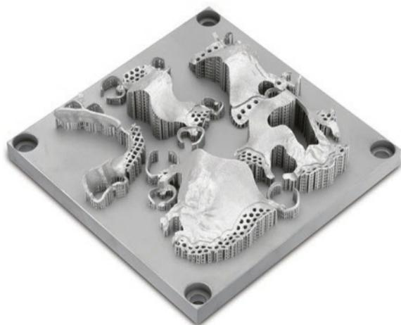
Abb. 2 Der aus Wironium RP im SLM-Verfahren bei Bego in Bremen gefertigte Modellguss erfreut sich wachsender Beliebtheit.
