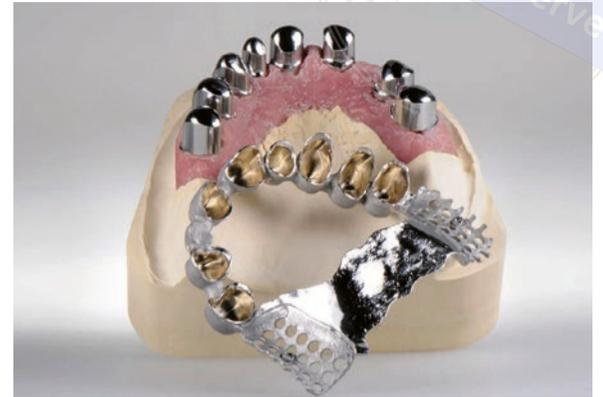
Abb. 1 Teleskopgestützter Zahnersatz aus einer SLM-Maschine: Multimaterialdruck und ein nachgeschalteter Fräsprozess (Hybridfertigung) machen es möglich.
