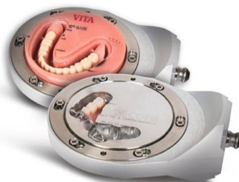
Abb. 2: Das Produktionssystem CORiTEC Mythos arbeitet vollautomatisiert und kombiniert ein hochpräzises Fünf-Achs-Fräsen mit einem 3D-Drucksystem. Dank des Einsatzes unterschiedlicher Fräsrohlinge und Kartuschen sowie der Hybridfertigung werden die Herstellung komplexer, dreidimensionaler Formen sowie die Verarbeitung verschiedener Materialien in einem einzigen Prozess möglich.
