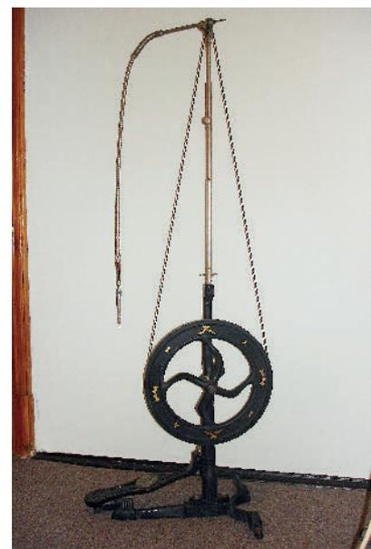
**Abbildung 1** Von Morrison 1871 aus einem Spinnrad entwickelte Tretbohrmaschine.
