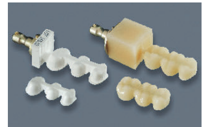
Abbildung 12 Rapid Layer Verblendung: Links ZrO 2 -Gerüst gefräst und gesintert, rechts: Verblendung ausgeschliffen und poliert.
