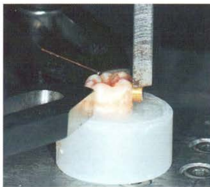
Abbildung 6 Prüfkörper in der Universalprüfmaschine. Figure 6 Test specimen in universal testing machine.
