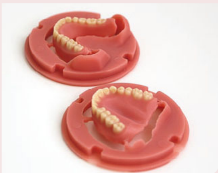
Abb. 11 Die vom Hersteller gelieferten Prothesenrohlinge werden nach der digitalen Konstruktion im Labor CAD/CAM-basiert gefräst.
