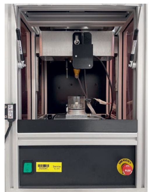
Abb. 2 Die revolutionäre Abrasionsmaschine vereinigt die Kausimulation und Digitalisierung der zu erfassenden Daten und bietet eine standardisierte Prüfmethode.
