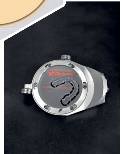
Abb. 7 Gefräste Schiene direkt nach der Entnahme aus der Fräsmaschine.
