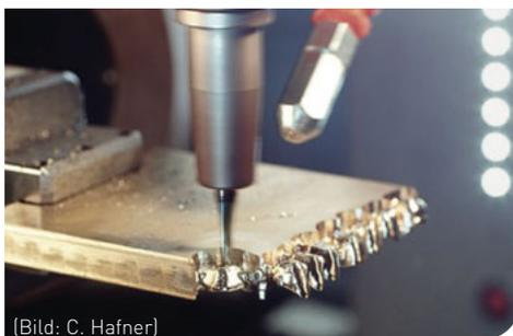
**Abb. 2** Fräsen (CAM) der Restauration aus einer Goldlegierung
