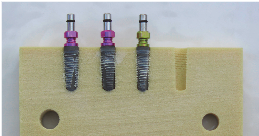
Abbildung 1 Getrimmter und geöffneter Kunstknochenblock mit 3 Implantaten und einer Kavität (von links nach rechts Implantat/Kavität A, B, C, D).
