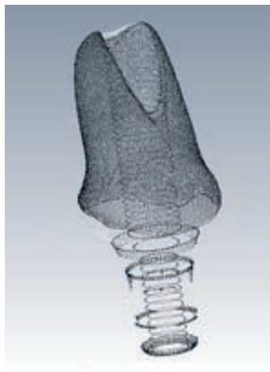
Abbildung 1 Virtuelles Design mit CAD-Programm zur Konstruktion von individuellen Implantatabutments mit patientenspezifischem Emergenzprofil.
