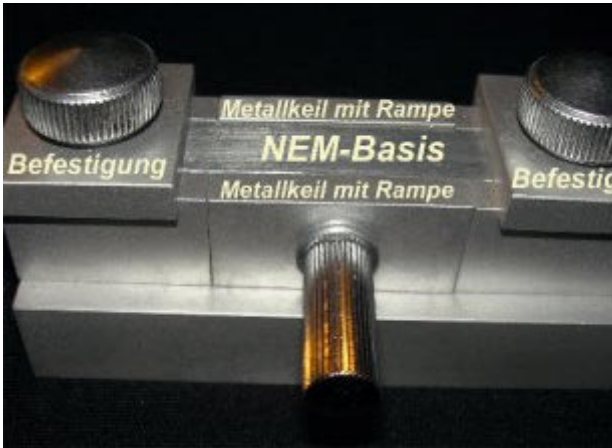
Abbildung 1 Vorrichtung zum definierten Opakerauftrag. (Abb. 1-7 und Tab. 1-2: A. Schwandt)
