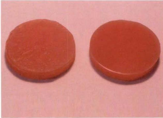
**Abbildung 1** Prüfkörper; Prüfkörpergeometrie für die Bürstmaschine: Flachzylinder mit  $D \approx 32$  mm,  $H \approx 3$  mm; links: direkt nach der Herstellung, rechts: für die Versuche vorbereiteter Prüfkörper.
