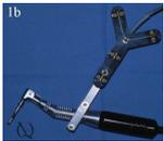
Abb. 1b (Navigierbares Winkelstück): Die Position der Bohrspitze und die Richtung der Bohrachse werden durch den angebrachten Infrarot-LED-Träger übermittelt.
