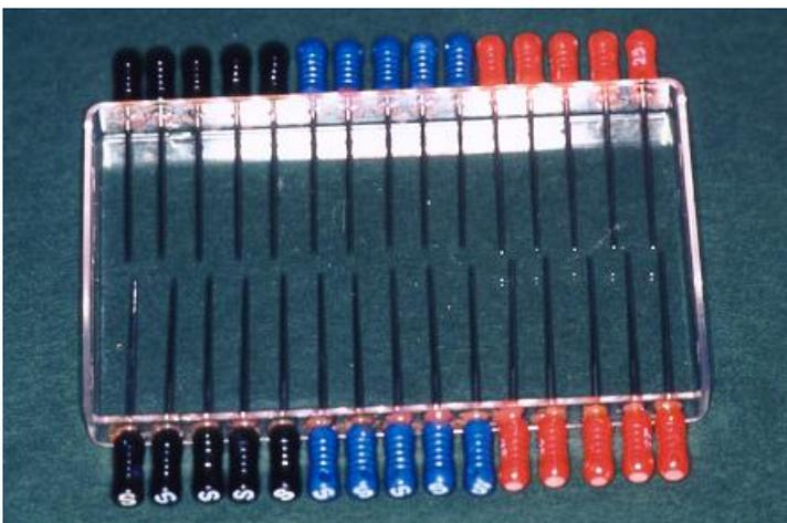
Abb. 1 Zur Einbettung in transparentem Kunststoff vorbereitete Fingerspreader für die Herstellung ISO-genormter Kanallumina
