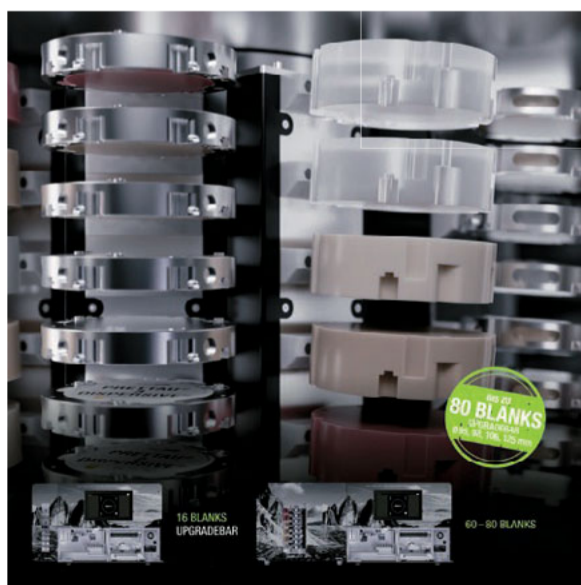
Abb. 15 Das Fräsgerät M6 Teleskoper Blank Changer ist mit einem upgradebaren Blankmagazin für bis zu 16 oder bis zu 80 Blanks erhältlich. So lässt sich je nach Laborstruktur eine gewisse Zahl an Blanks in unterschiedlichen Farben, Höhen und aus unterschiedlichen Materialien bearbeiten. Die Maschine dient somit als Lager und weiß nach dem Einlegen des jeweiligen Blanks im Magazin, was sich von nun an im „Lager“ befindet, sodass bei Bedarf darauf zurückgegriffen werden kann.
