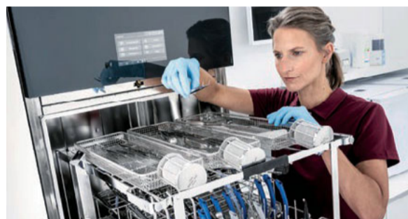
Abb. 2 Drei Ebenen für die Aufbereitung von Instrumentensets, Siebschalen und Trays: Thermodesinfektoren der Baureihe SlimLine lassen sich flexibel mit Modulen für alle gängigen Instrumente bestücken.
