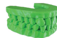
Abb. 6. Modell mit Hufeisensockel mittels FDM-Drucker in PLA gedruckt.
