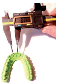
Abb. 8. Digitaler Messschieber mit modifizierten Spitzen und direktem USB-Anschluss.
