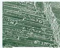
Abb. 4: Gruppe DP/P: Zementbedecke und nahezu freiliegende Fibergläser (V 500x)
