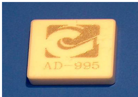
Keramikprüfkörper AD-995 der Firma CoorsTek®
