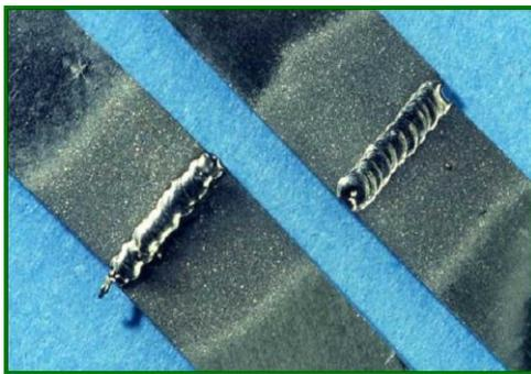
Abb. 6: Laserfugungen von Titan, makroskopische Aufnahme
