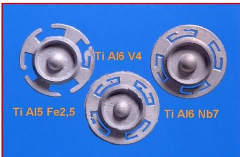
Abb. 8: Formfüllungsvermögen von TiAl5Fe2,5, TiAl6V4, TiAl6Nb7 Legierungen
