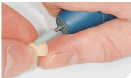
Abb. 2 Ausarbeiten einer keramischen Krone mit einem DCB-Schleifer (Fa. Komet). (Foto: Heike Assmann)
