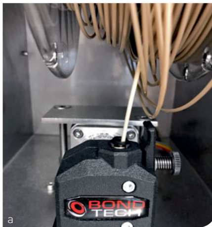
Abb. 7a und b Gegenüberstellung von Filament-Drucker und DLP-/SLA-Drucker: In der Spule des Filamentdruckers wird ein Stangen-Filament durch den Heizkopf erwärmt und mittels eines Extruders Schicht für Schicht auf die Bauplattform appliziert (a). Aus der mit photosensitivem Harz gefüllten Wanne des DLP-/SLA-Druckers „wächst“ das zu druckende Objekt Schicht für Schicht aus dem flüssigen Harz und härtet mittels Polymerisation aus (b).
