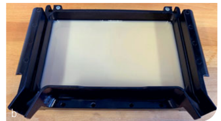
Abb. 7a und b Gegenüberstellung von Filament-Drucker und DLP-/SLA-Drucker: In der Spule des Filamentdruckers wird ein Stangen-Filament durch den Heizkopf erwärmt und mittels eines Extruders Schicht für Schicht auf die Bauplattform appliziert (a). Aus der mit photosensitivem Harz gefüllten Wanne des DLP-/SLA-Druckers „wächst“ das zu druckende Objekt Schicht für Schicht aus dem flüssigen Harz und härtet mittels Polymerisation aus (b).
