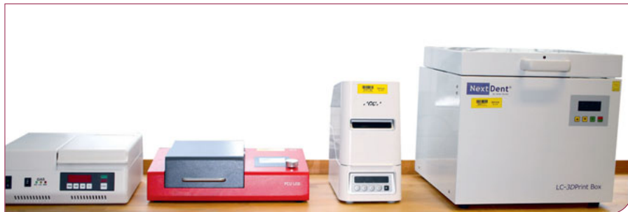
Abb. 8 Beispielhafte Darstellung verschiedener Nachbelichtungsgeräte (v. l. n. r.): Otofash G171, Fa. NK Optik; PCU LED, Fa. Dreve; Labolight DUO, Fa. GC; LC-3D Printbox, Fa. NextDent.
