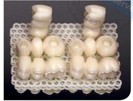
Abb. 5 Unterschiedliche Möglichkeiten der Ausrichtung einer Brücke auf der Bauplattform: Die Ausrichtung beeinflusst u. a. die Druckzeit. Vertikal ausgerichtete Strukturen benötigen eine längere Druckzeit, da mehr Schichten vonnöten sind.
