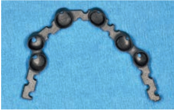
Abbildung 2.5 Tertiärgerüst, hergestellt durch selektives Laserschmelzen
