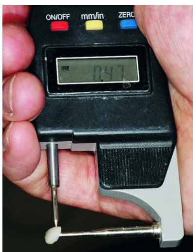
Abbildung 13 Messung der Veneer-Wandstärke (hier 0,47 mm dick).
