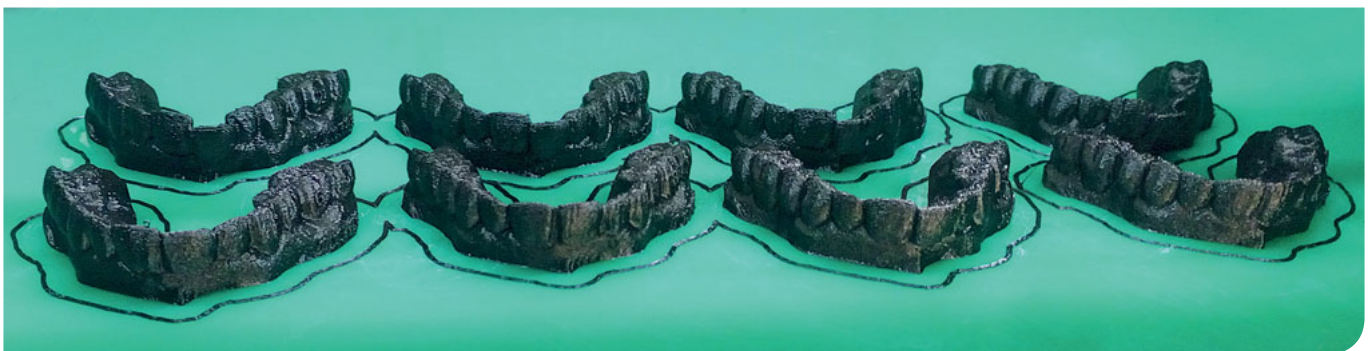
Abb. 1 FDM-gedruckte Modelle (PET-G) auf der Bauplattform mit Hufeisensockel für die Alignerherstellung.
