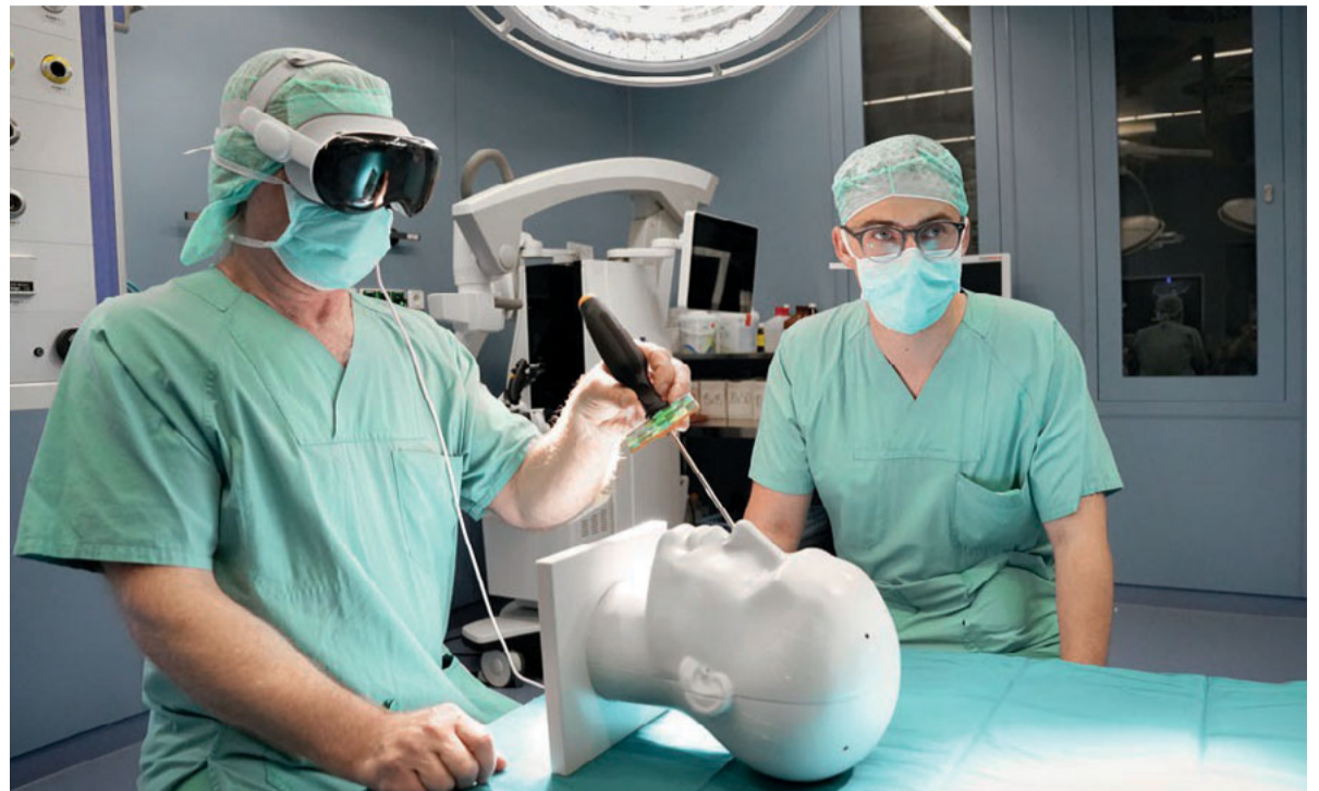
Abb. 1 Neurochirurg Prof. Dr. Dirk Winkler und Informatiker Conrad Günther (UKL) testen die App für die neurochirurgische Spatial Navigation an einem Modellkopf. Der operierende Arzt kann sein Instrument dank der in einer Standard-Datenbrille visualisierten realen und virtuellen Informationen („Mixed Reality“) sicher führen und die Verletzungsgefahr für Patientinnen und Patienten minimieren.
