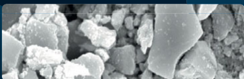
Im REM-Bild ganz deutlich zu erkennen: Die Perlenstruktur von OMNICHROMA im Vergleich zu herkömmlich gestoßenen Partikeln.
