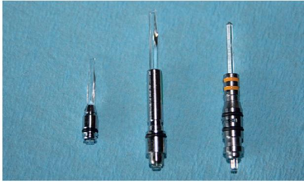
**Abbildung 2** Beispiele für Faserspitzen von Er:YAG-Lasern, links 2 spatelförmige Spitzen mit axialem Lichtaustritt und rechts eine, die einen seitlichen Lichtaustritt ermöglicht.
