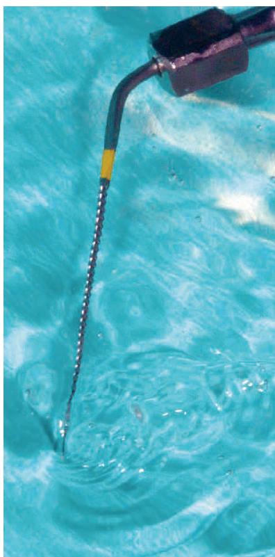
Abbildung 8 Schwingende Ultraschallnadel. Zu sehen ist, wie sich die Strömungsphänomene in der Flüssigkeit fortsetzen.
