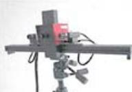
Abb. 1: Profilometrisches 3D-Messsystem
