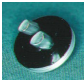
Abb. 2: Präparierte Titanprüfkörper für REM-Untersuchung
