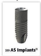
Das Implantatdesign ist das Ergebnis intensiver Grundlagenforschung in interdisziplinärer Kooperation. Die Abstimmung des Steigungsverhältnisses (2:1) des apikalen Haupt- zum koronalen Feingewinde erlaubt hohe Primärfestigkeiten und beste Voraussetzungen für eine rasche Osseointegration. Es stehen sechs Durchmesser (3, 3,5, 4, 4,7, 5 und 5,5 Millimeter) sowie vier Längen (6,
