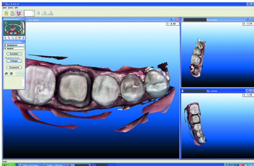
Abbildung 11 Screenshot eines virtuellen Modells des Zahnes 46 (klinisches Beispiel), welches aus Einzelabformungen mit dem iTero Scanner erstellt wurde. Zum Vergleich: Der gleiche Zahn wurde auch mit der Cerec AC abgeformt (s. Abb. 2). Figure 11 Screenshot of a computer model of a lower right first molar, which was calculated by matching single impressions. The same tooth was acquired with Cerec AC (please see figure 2).
