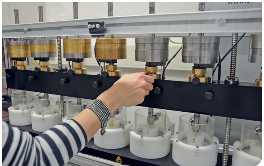
**Abb. 2** Einsetzen von Prüfkörpern in den Kausimulator.
