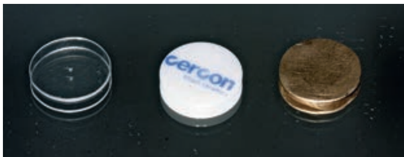
Abbildung 5 Messproben (PMMA, Zirkoniumdioxid, Goldlegierung).
