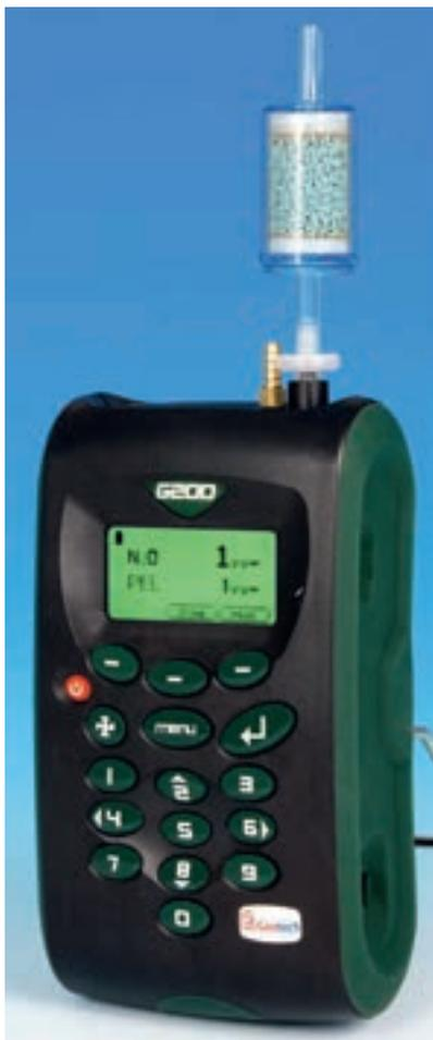
**Abbildung 6** Gerät zur Messung der Raumluftkonzentration von  $N_2O$ , 0–1000 ppm, G200 Geotechnical Instruments (UK) Ltd., <http://www.geotechuk.com/>.
