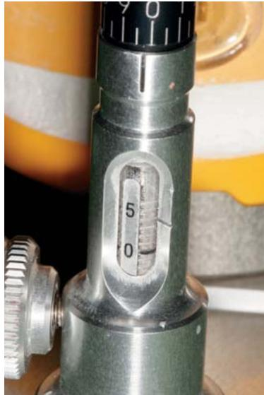
**Abb. 9-136** Artikulatorstützstift mit Mikrometerschraube.
