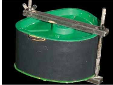
**Abb. 9-123** Kuvette (Axiosplit) zur Herstellung des Funktionsmodells.
