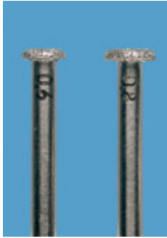
Abb. 4-35 Mit Diamant-rädern unterschiedlicher Schnitttiefen lassen sich Tiefenmarkierungen anlegen, die einen kontrollierten Substanzabtrag ermöglichen. Für presskeramische Restaurationen sind Rillenschleifer von 0,6 und 0,8 mm sinnvoll einsetzbar.
