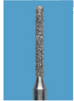
Abb. 4-37 Ein zylindrisches, vor Kopf rundes Diamantinstrument mit einem Durchmesser von 1,0 mm eignet sich sowohl zur Anlage der inzisalen Tiefenmarkierung als auch zur Vorpräparation.
