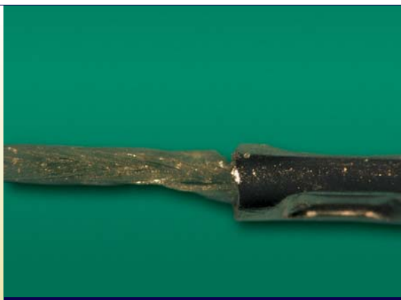
Verbindung Nadel/Faden: Polyester, geflochtener synthetischer Faden, Flanschanschluss, mäßige Kongruenz zwischen Nadel und Faden, Ethibond 4-0.
