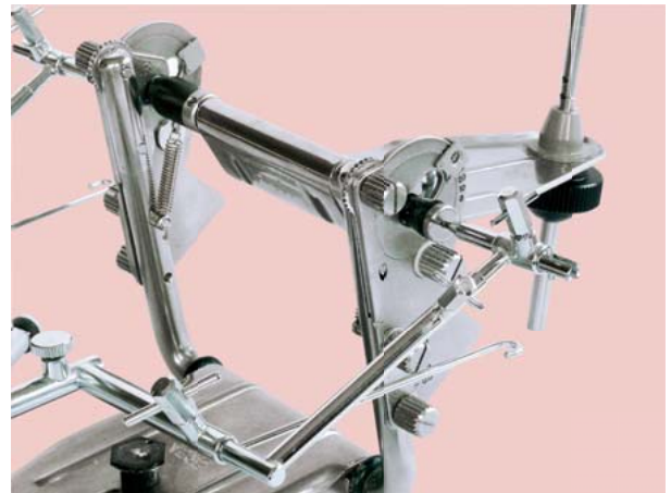
Abb. 10-1 Teilansicht des Gesichtsbogens – ausgerichtet auf das Zentrum der Condylatorachse.
