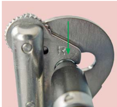
Abb. 10-3 Die Pfeile zeigen auf die Elemente, die zur Fixierung der Zentrik relevant sind und in Nullstellung oder individuell eingestellt werden müssen.
