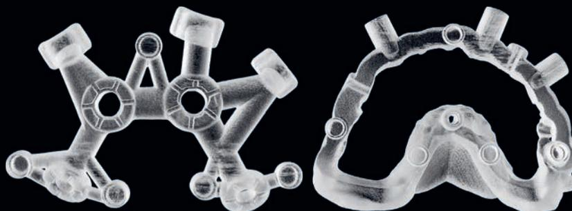
**FIGG. 23/24** Guide chirurgiche dopo la rimozione del materiale di supporto e la pulizia.
