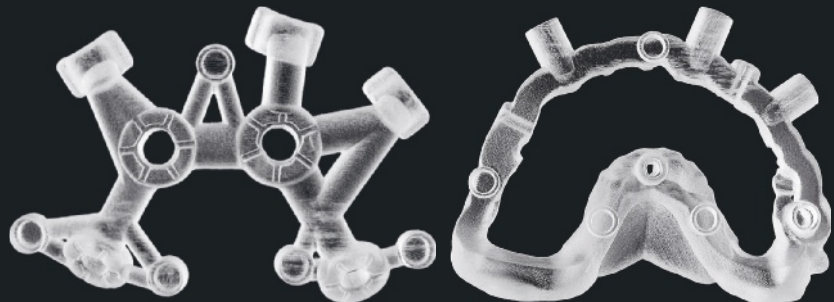
Abb. 23 und 24 Chirurgieschablone nach Entfernen der Stützstrukturen und Reinigung.
