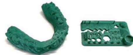
Abb.2: Modell und Testplatte am Bsp. ecoPLA
