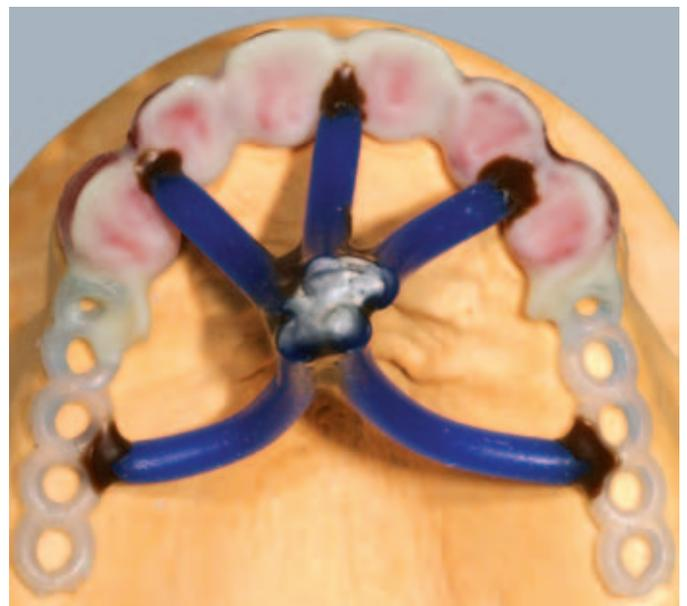
Abb. 25 Das Gusskanalsystem muss für die verwendete Legierung geeignet sein und darf auf keinen Fall Spannungen erzeugen.
