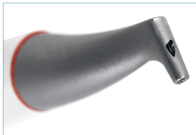
Abb. 7 Für die Sicherheit der Patienten und eine lange Lebensdauer des Instruments muss das verwendete Pulver auf dieses perfekt abgestimmt sein. Das Bild zeigt die beschädigte Düse eines Airflow-Handstücks nach Anwendung eines mit Apatit beschichteten Pulvers (vgl. Abb. 5).
