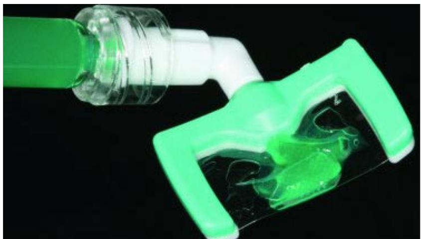
**Abbildung 4** Die Applikationshilfe für die proximale Anwendung besteht aus einer Drehspritze (Drehung 360°) an die eine sehr dünne, zweilagige Folientasche aufgeschraubt wird. Die Materialien „Icon-Etch“ (hier dargestellt) oder „Icon-Infiltrant“ treten durch Poren, die sich auf nur einer Seite der Folie befinden, an die entsprechende kariöse Zahnfläche aus.
