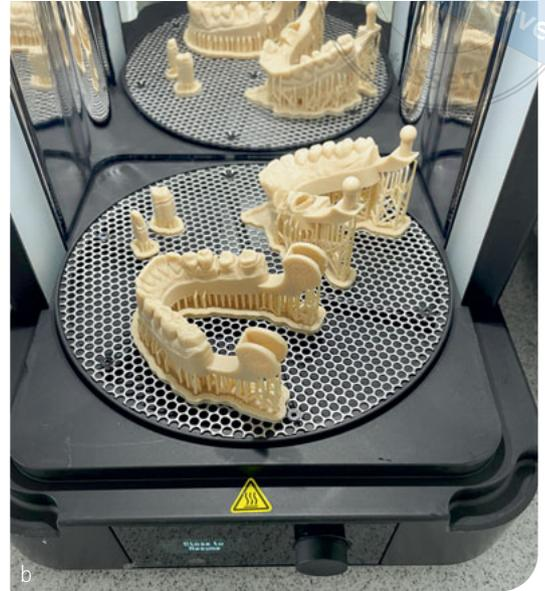
Abb. 5a und b Verschiedene Modelle im Drucker und Lichtofen (ZT: Markus Lenhardt).
